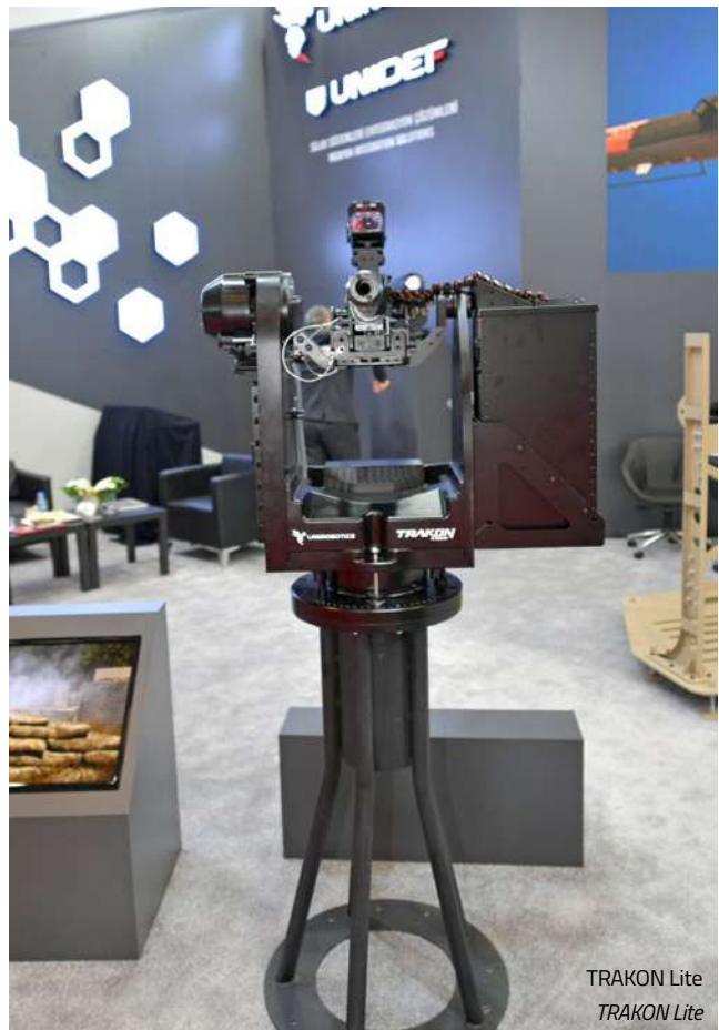
30 mm'lik VENOM LR topunu taşıyan TRAKON silah kulesi. TRAKON turret armed with 30 mm VENOM LR cannon
