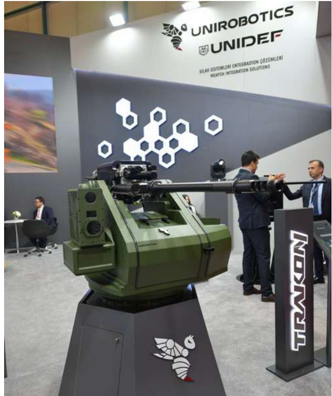
30 mm'lik VENOM LR topunu taşıyan TRAKON silah kulesi. TRAKON turret armed with 30 mm VENOM LR cannon
